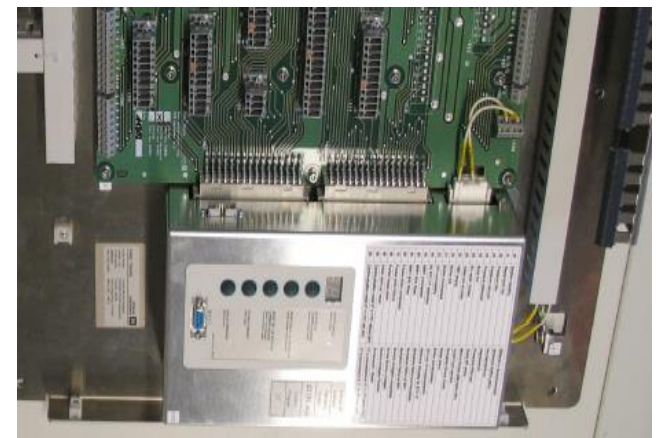
Steuertafel in PCB-Technik, ca. 2h Fertigungszeit
